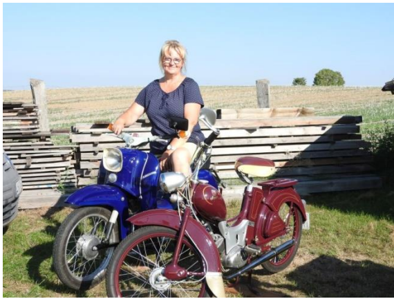
Astrid auf ihre Simson „Schwalbe“, davor ein Moped SR2 von 1958. Moped ist ein Kunstwort aus „Motor“ und „Pedale“. Der Motor des SR2 wurde durch treten der Pedale gestartet. Die Leistung lag bei 1,8 PS.
