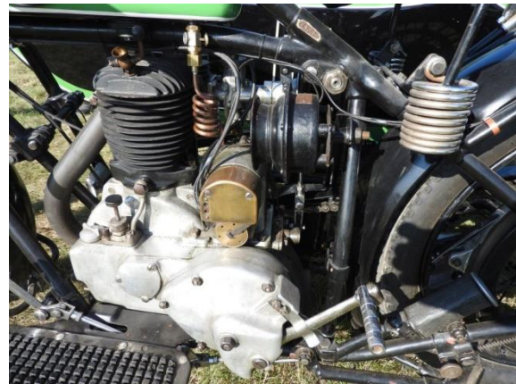
Der Motor der R04 hat einen Hubraum von 247 ccm und leistet 8 PS.
