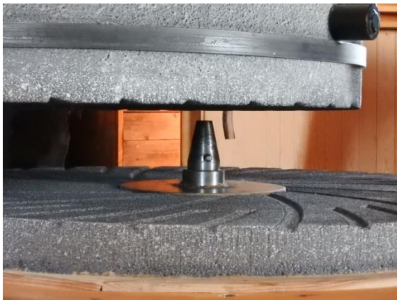
Der Läuferstein wird nun wieder in den Mahlgang eingebaut. Präzision ist auch beim Aufsetzen auf die Welle notwendig.
