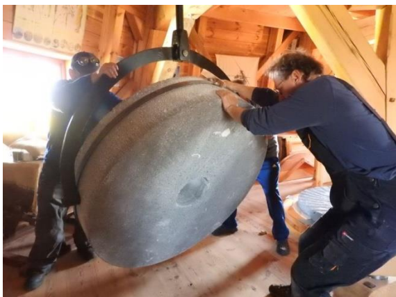
Der Läufer wird gedreht, so dass die Seite mit den Schärfe nach oben zeigt.
