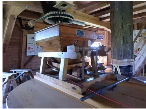
Das Gehäuse des Mahlganges ist hier wieder zusammengebaut, der Getreidetrichter und der Rüttelschuh sind aufgesetzt.
