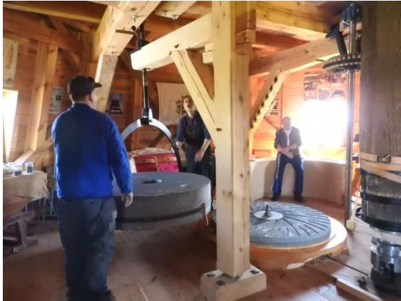
Der Läuferstein ist abgehoben.
