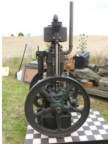
Dieser Deutz-Viertakt-Ottomotor vom Typ MA608 wurde von Peter Gosemann gezeigt. Er hat mit einer Bohrung von 70 mm und einem Hub von 80 mm einen Hubraum von 308 cm<sup>3</sup> und leistet 4 PS bei 2000 Umdrehungen. Die Kühlung erfolgt durch Verdampfung. Dieser Motor wurde in großen Stückzahlen gebaut: rund 55.00 Stück wurden von 1931 bis 1954 hergestellt. Das ausgestellte Exemplar trägt die Nr. 42705.<sup>5</sup>
