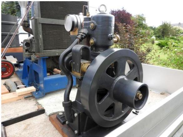
Dieser Alexander-Motor Nr.435 der Firma Heinrich Schenk Berlin wird mit Benzin angetrieben. Er diente in einer Stellmacherei in Werneuchen in klassischer Weise als Antrieb für eine Transmission. Es handelt sich um einen Viertakter mit zwei Ventilen und einer Leistung von ca. 5 PS aus den 1920er Jahren.
