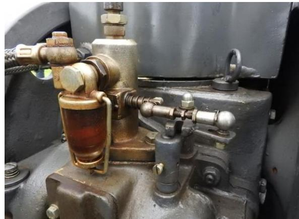
Dieser Viertakt-Dieselmotor LD120 aus dem Motorenwerk Cunewalde arbeitet mit einer Verdampferkühlung. Das Kühlwasser muss daher regelmäßig nachgefüllt werden. Der Motor hat eine Bohrung von 100 mm, einen Hub von 120 mm und damit einen Hubraum von knapp 1l. Er leistet 7 PS bei 1500 Umdrehungen und wurde von 1952 bis 1957 hergestellt.<sup>4</sup> Der Einsatz solcher Motoren erfolgte im Bergbau als Antrieb für Wasserpumpen, aber auch in der Landwirtschaft.
