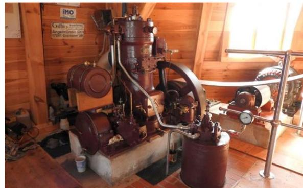
Der erste stationäre Motor in der Mühle Greiffenberg ist ein Dieselmotor vom Typ KZ26. Er wurde von den Deutschen Werken Kiel in den 20er Jahren hergestellt und hat eine Leistung von 22 PS. Die Rekonstruktion der schrottreifen Maschine wurde mit Hilfe mehrerer Firmen aus dem Umland durchgeführt<sup>3</sup>. Beim Stationärmotortreffen wurde diese Maschine im Betrieb vorgeführt.
